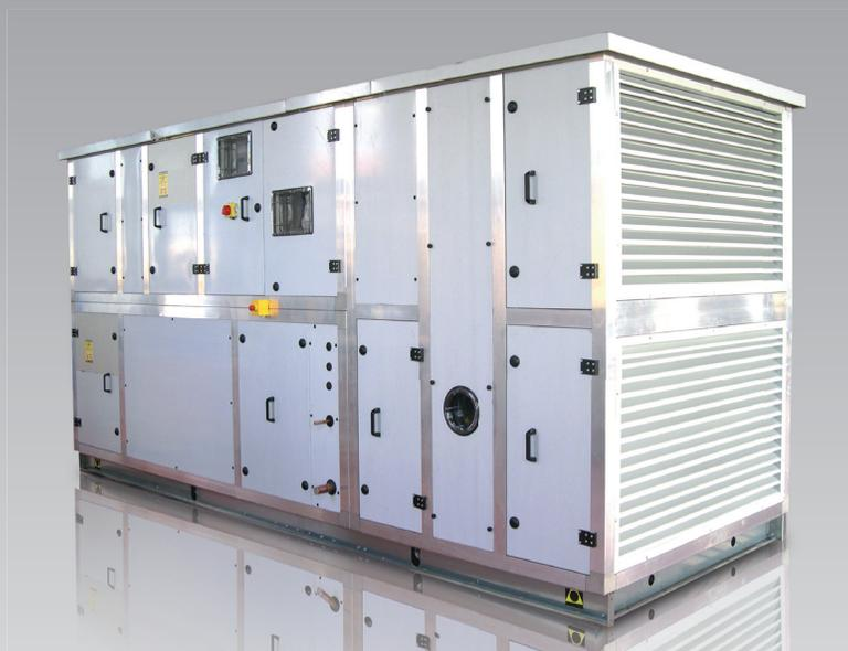
Характерной особенностью серии CFRS-AHU является теплообменник поперечного потока на алюминиевой пластине (средний КПД 55%). Серия CFRS-AHU снабжена абсорбирующим или поворотным теплообменником, позволяющим осуществлять рекуперацию скрытого и сухого тепла с максимальным КПД 70%.
